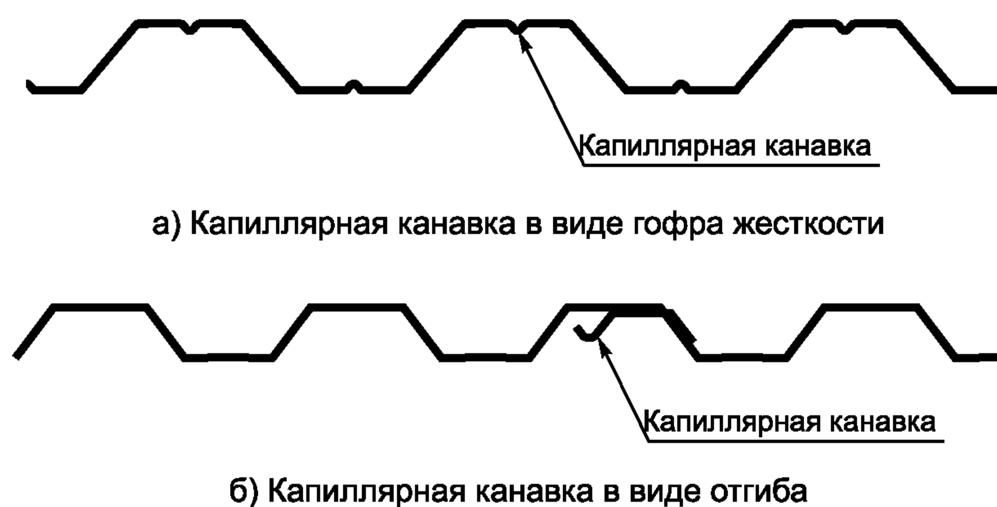
Рисунок 3 — Основные виды капиллярных канавок
